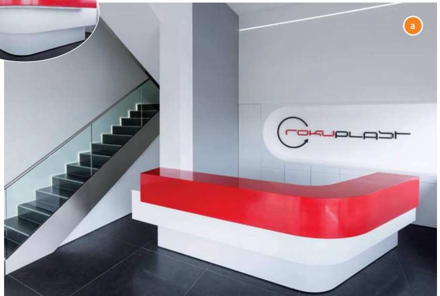
Abb. 8a: Dank Varicolor konnte das CI-Rot genau getroffen werden. – Abb. 8b: Der rote Tresenaufsatz besteht aus vier Teilen, die letztlich fugenlos poliert wurden.
